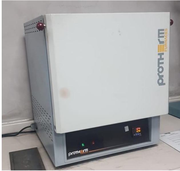
Şekil 3. Çözeltiye alma ve yaşlandırma fırını (Solution and aging furnace)
