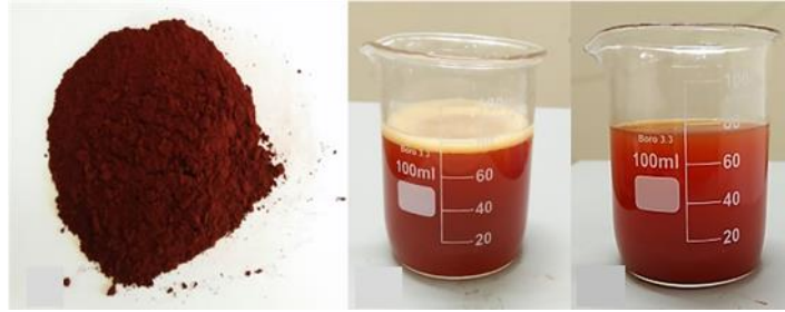
Şekil 5. Fe_2O_3 nanoparçacığı ile nanoakışkan elde edilmesi (Obtaining nanofluid with Fe_2O_3 nanoparticle) [26]
