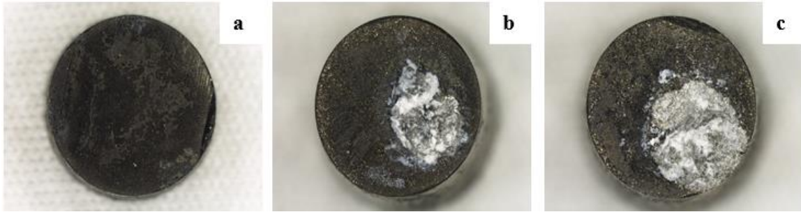
Şekil 9. Daldırma korozyon testi sonrası yüzeyden alınan makro fotoğraflar ( Macro-photos was taken from the surface after immersion corrosion test )
