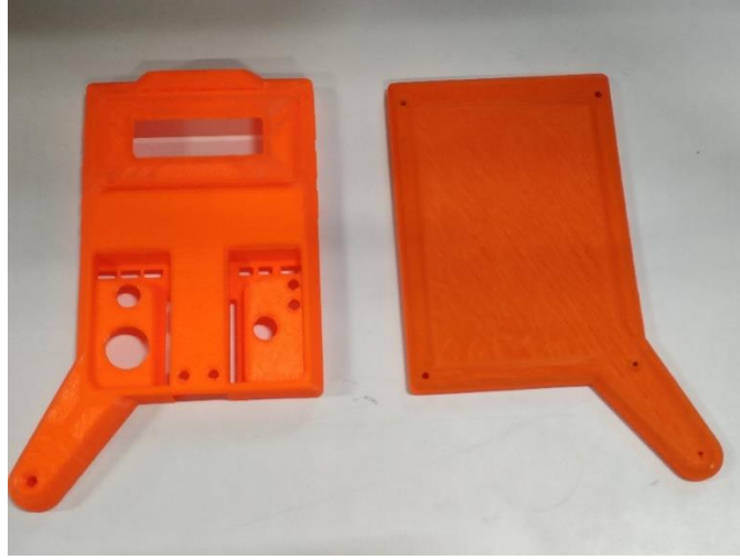
Şekil 9. Üç boyutlu yazıcıdan elde edilmiş dış kabuk görüntüsü (Outer shell image obtained from a 3D printer)
