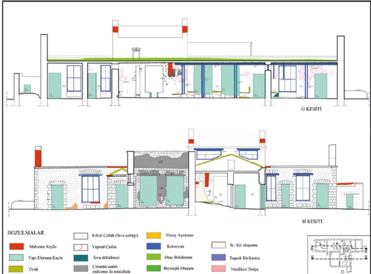
Şekil 12: Yapıdaki bozulmaları gösteren çizimler / Drawings of deteriorations
