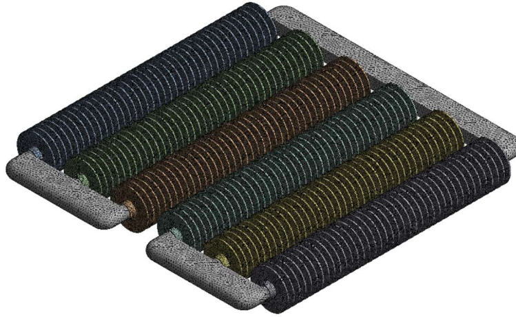
Figure 2. The mesh structure of Type-B channel heat sink. Şekil 2. Tip-B kanallı ısı alıcının ağ yapısı
