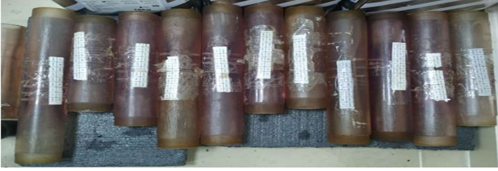
Şekil 4. İç ve dış kalıplardan ayrılmış venturiler (Turgut, 2019)
