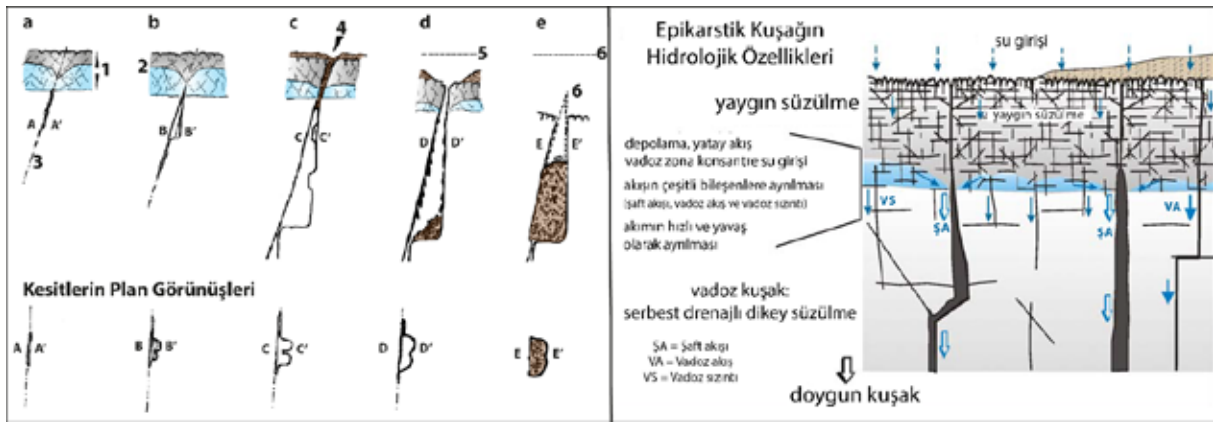
Şekil 8: Epikarstik kuşak etkisinde baca (saft) gelişiminin genelleştirilmiş çizimi (solda): a) embriyonik (ilksel, gelişmemiş) mağara aşaması; b,c) genç baca aşaması (damlama yoluyla oluşmuş model); d) gelişmiş baca e) relikt baca. 1) epikarstik kuşak; 2) tünemiş akifer seviyesi; 4) başlangıç aşamasındaki çukurluk 5) eski aşınım yüzeyi; 6) relikt bacadan eski üst seviyesi (Baron (2002, s.6)'dan yeniden düzenlenerek alınmıştır). Epikarstın yapısal ve hidrolojik özelliklerini gösteren diyagram (Klimchouk (2004, s.2)'dan düzenlenerek alınmıştır) (sağda).
