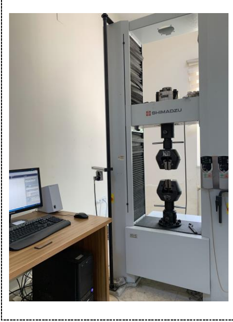
Şekil 3. Shimadzu marka çekme testi cihazı
