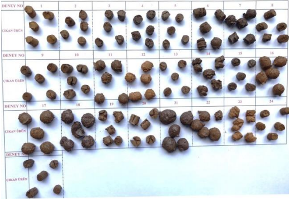
Şekil 3. Deneyler sonucunda üretilmiş genleşmiş kil bilyeleri (Figure 3. Expanded clay balls produced as a result of experiments)
