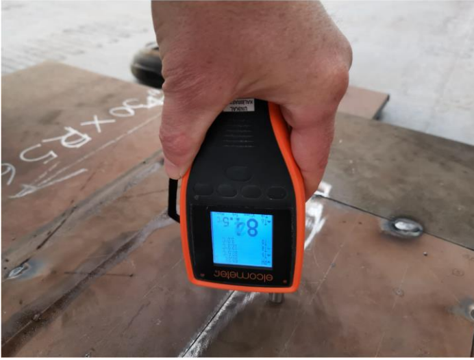
Şekil 2. Ön Tav Sonrası Numune Saclardaki Sıcaklık Değeri (Figure 2. Temperature Value in Samples Sheets After Preheat)
