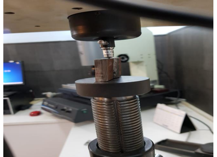
Şekil 4. Vickers Sertlik Ölçüm Deneyi (Figure 4. Vickers Hardness Measurement Experiment)
