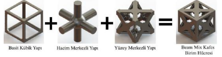
Şekil 1. Beam-Mix Kafes Birim Hücresi
