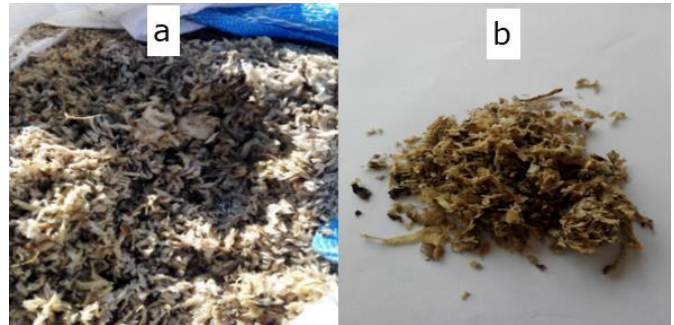
Şekil 1. (a) Deneylerde kullanılan şeker pancarı küspesi ve (b) bantlı kurutma sonrası.
