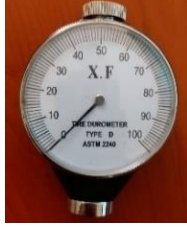
Şekil 6. X.F Shore-D sertlik ölçüm cihazı (Akdoğan, 2020)
