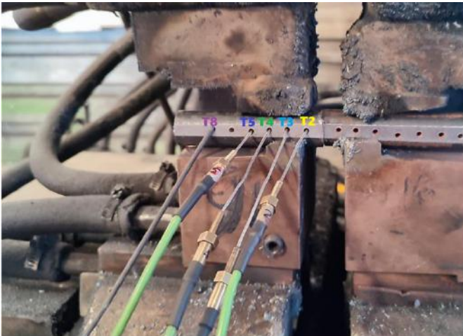
Şekil 6. Termokuplların numune üzerindeki dizimliliği
