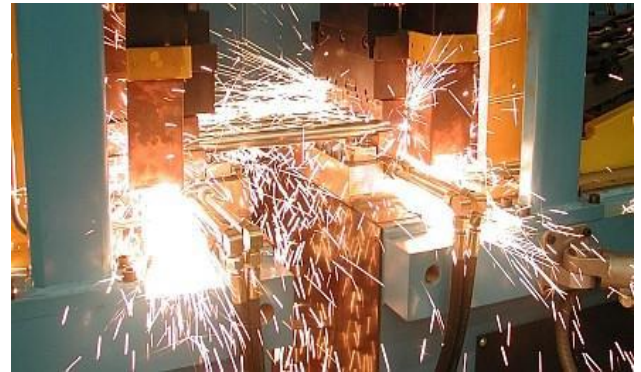
Şekil 4. Yakma alın kaynağında örnek yanma işlemi [9].
