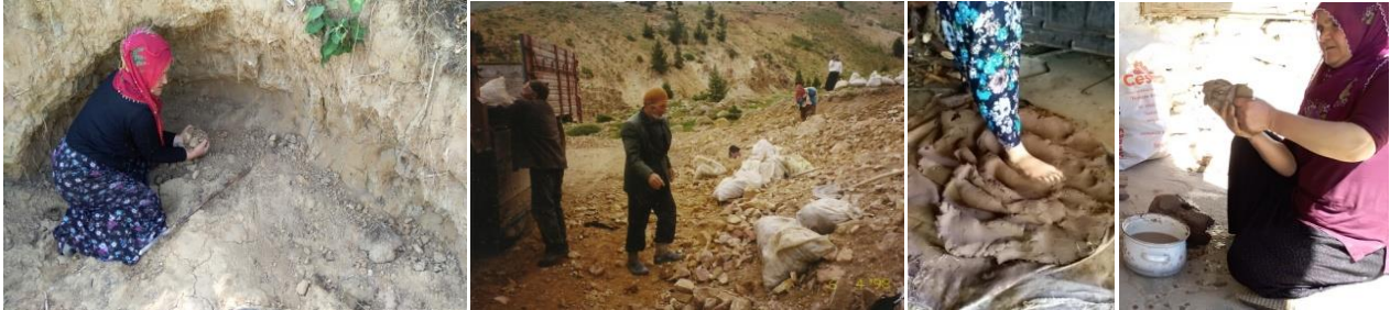
Şekil 3. Güveç Çamurunun Çıkarılması, Köye Taşınması, Ayakla Basılması ve Ellenmesi.
