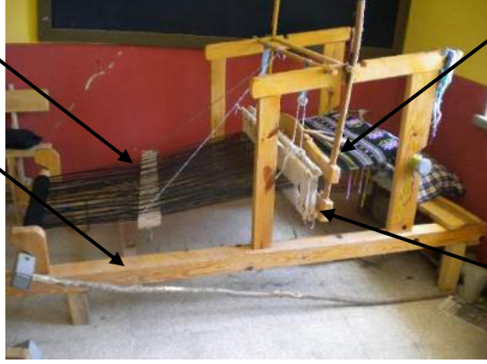
Fotoğraf 4. *Gücü- **desen kaldırma tahtası- ***gergi sopası- ****yan sopası (Özcan, 2021)
