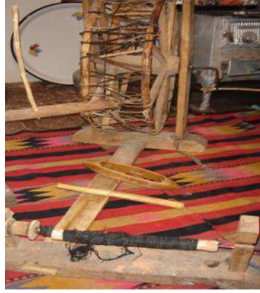
Fotoğraf 11. Aba, şayak çözgü ve atkı ipliklerinin eğrildiği çıkırıktaki (rudan) ve düzeneği Berna Sevinç arşivi
