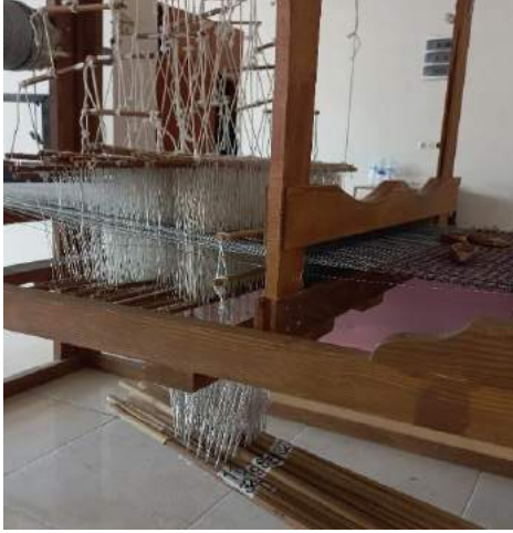
Foto 20: Tezgâhın gücü çerçeve detayı
