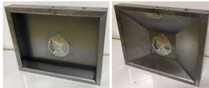
Şekil 2. Deneysel test için hazırlanan prototipler, a) HYK’sız model, b) HYK’lı model
