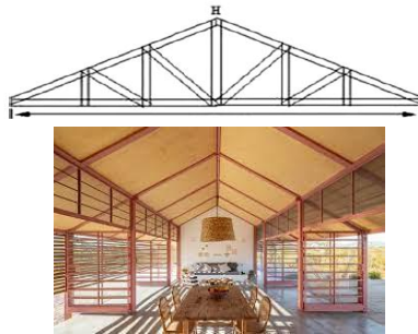
Şekil 6. Brezilya çatı inşasında kullanılan bir kalkanın şeması. Bk. (URL-3).
