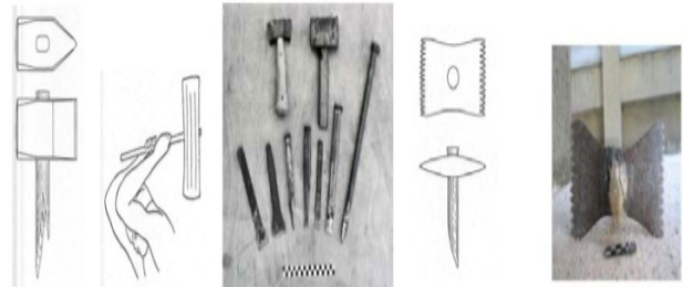
Şekil 8. Eski taş işçiliğinde kullanılan araçlara örnekler (ankdem).
