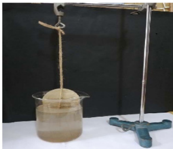
Şekil 3. Kerpiç için seçilen toprağın çamurlaşma deneyi.
