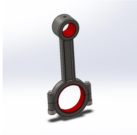
Şekil 2. Biyel Kolunun 3D Modellenmesi
