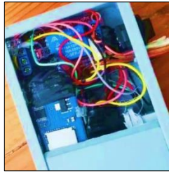
Şekil 4. Ölçümleri toplayıp, değerlendiren Arduino devresi
