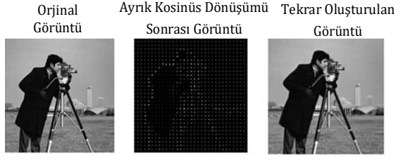
Şekil 8. 3 Boyutlu Ayırık Kosinüs Dönüşümü ile görüntü sıkıştırma ve geri oluşturma [35]
