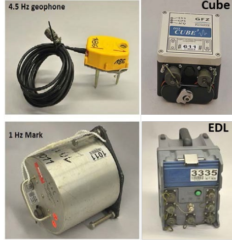
Şekil 5. İstasyonlarda kullanılan sensör (1 Hz Mark ve 4.5 Hz Geophone) ve kayıtçılar (EDL ve CUBE). Figure 5. Sensor (1 Hz Mark and 4.5 Hz Geophone) and recorders (EDL and CUBE) used in stations.
