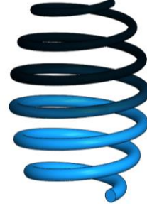
Şekil 3. Fonksiyonel derecelenmiş malzeme ve değişken kesitli varil tipi helisel çubuk
