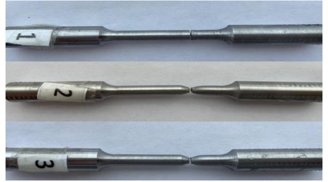
Şekil 13. Çekme sonrası S1, S2 ve S3 nolu numunelere ait yüzey görüntüleri
