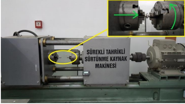
Şekil 2. Sürekli tahrikli sürtünme kaynak makinesi ve bağlanma şekli
