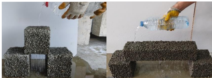
Şekil 8. Geçirimli betonların su geçirgenliği görünümü
