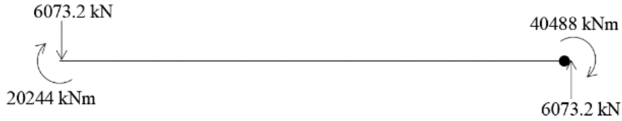
Şekil 8. Birinci plastik mafsalın birim dönmesinden oluşan ankastrelik uç kuvvetleri.
