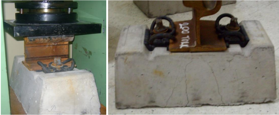
Şekil 10. Traverslerin basınç dayanımı deneyi
