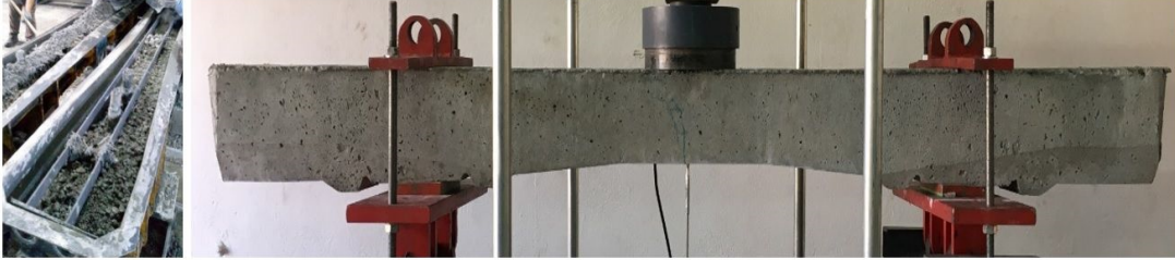
Şekil 6. Yeni geliştirilen 30-VRTC-SND tipi L-CFRPU donatılı betonarme demiryolu traversinin üretimi
