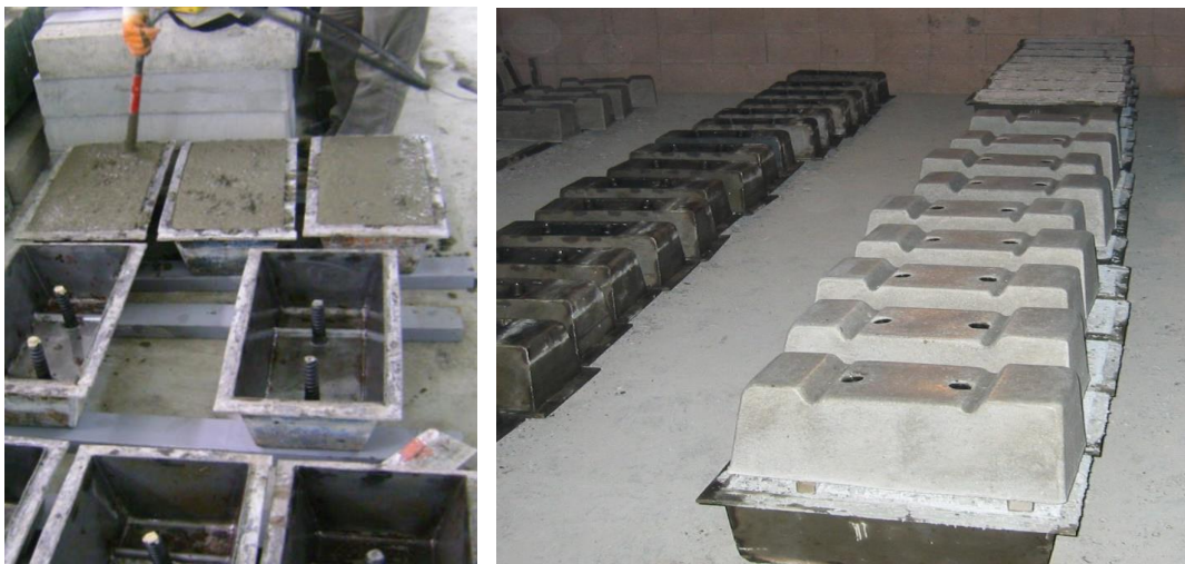
Şekil 5. LVT tipi ikiz-blok travers numune kalıpları ve üretilmesi
