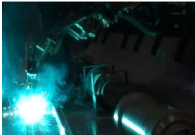
Şekil 3. TÜRASAŞ'ta yapılan tandem kaynak işlemi
