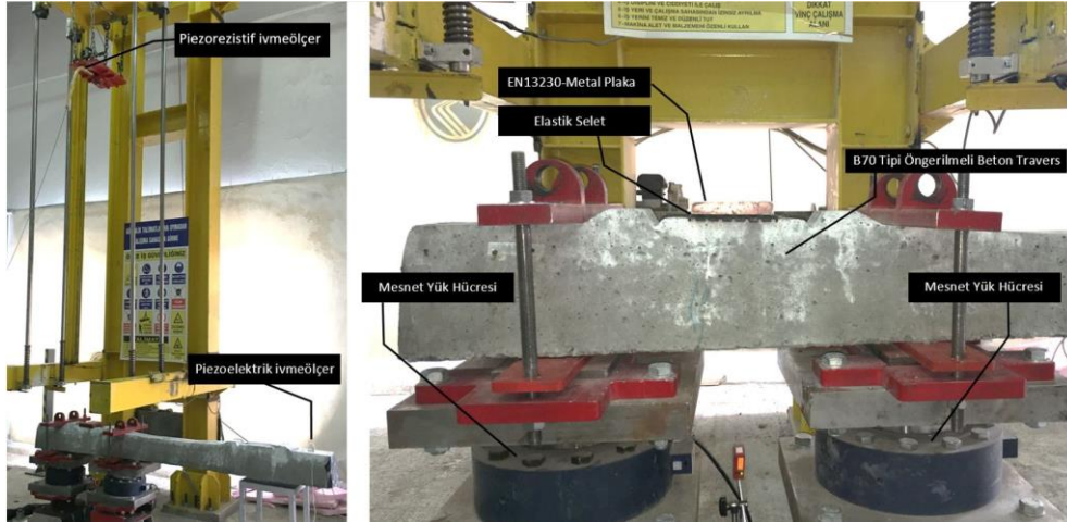
Şekil 6. Simülasyonlarda kullanılan çarpma çerçevesi, travers numunesi, ara yüzeyler ve sensörler
