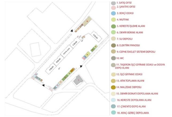
Şekil 6. Şantiye 4'e ait mevcut ve öneri şantiye yerleşim planı (Dinçel, 2019) Figure 6. Current and proposed site layout plan of construction site 4 (Dinçel, 2019)
