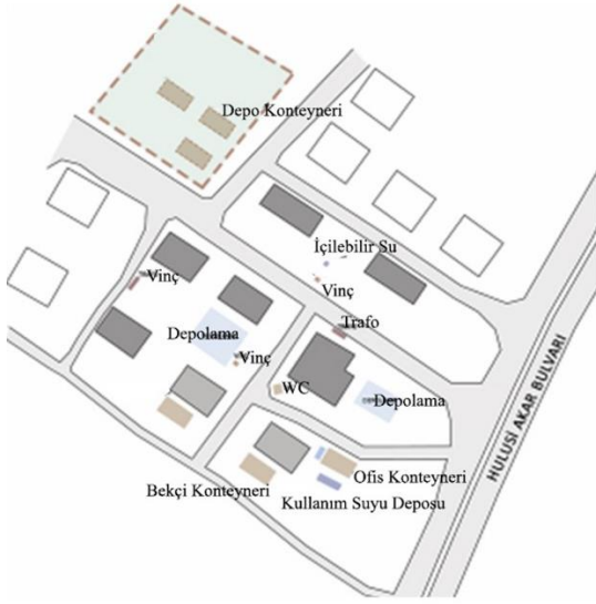
Şekil 10. Şantiye 8'e ait mevcut ve öneri şantiye yerleşim planı (Karaaslan, 2019)
