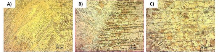
Şekil 5. AISI 316Ti kaynaklı numune için a) kaynak bölgesi, b) geçiş bölgesi, c) ana malzeme mikroyapı görüntüleri
