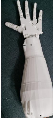
Şekil 3. Robot El için Ön Kol Montajı Yapılmış Hali
