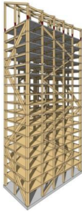
Şekil 7. Mjøstårnet Taşıyıcı Sistemi-Norveç [18]
