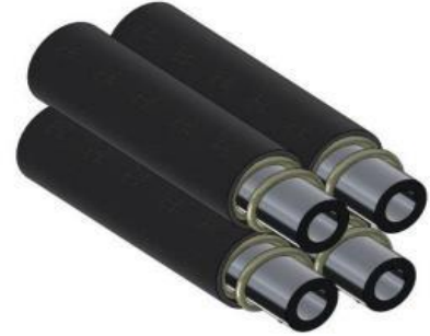
Şekil 5. 4 Borulu Elektrikli Isıtıcı Kompakt Isı Eşanjörü Tasarımı
