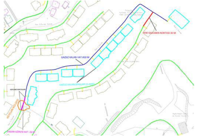
Şekil 4. Üzülmüş TOKİ Konutları 'nda heyelan sonrası gazsız kalan alanlar ve yeni gazlama noktası
