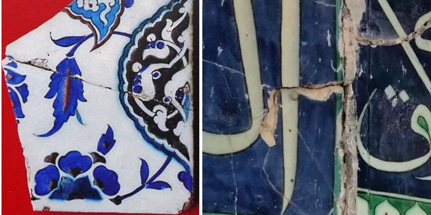
Resim 17. İznik çini fırınları kazı buluntusu çini hamurunda ve sırda kırık (Solda) (Arlı, 2018: 589).
