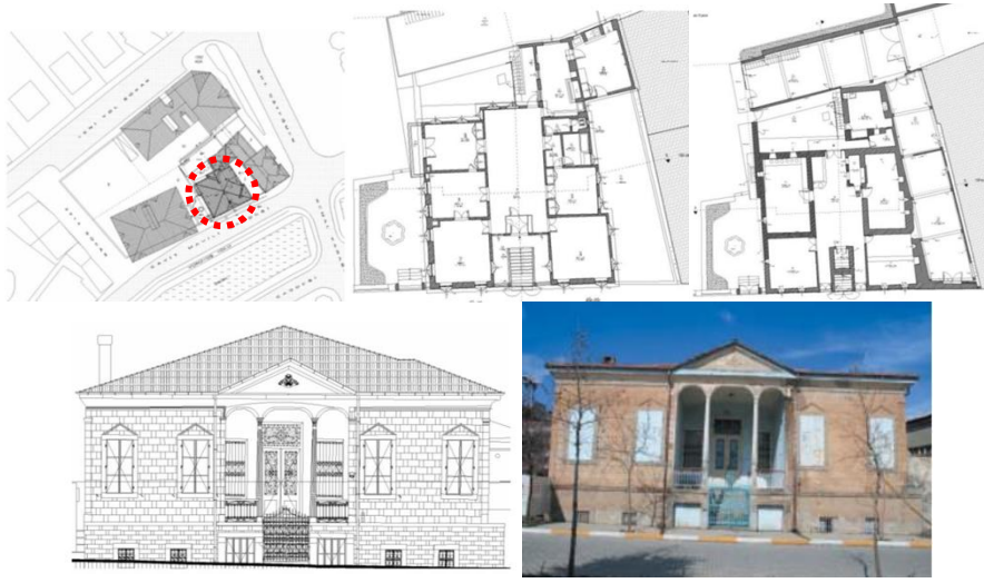
Şekil 2. Isparta Halkevi'nin 1933-1939 yılları arasında kullandığı Türk Ocağı Binasının vaziyet planı, kat planları ve güney cephesi (Bozdağ, 2013).
