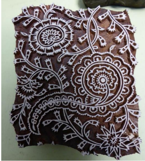
Fotoğraf 1. Kumaşa basmak üzere oyulmuş ahşap kalıp
