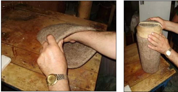
Resim 13. Sikenin kalıba alınma işlemi
