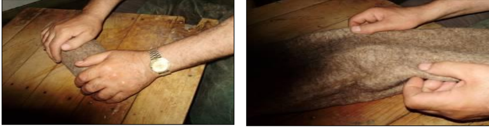
Resim 12. Sikkenin elde pişirilmesi işlemi
