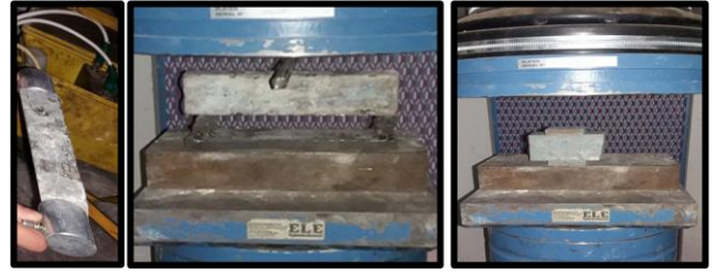
Şekil 3. Hafif beton numuneleri üzerinde yapılan deneyler
