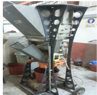
Resim 4- Sorgumun peletlendiği makine
