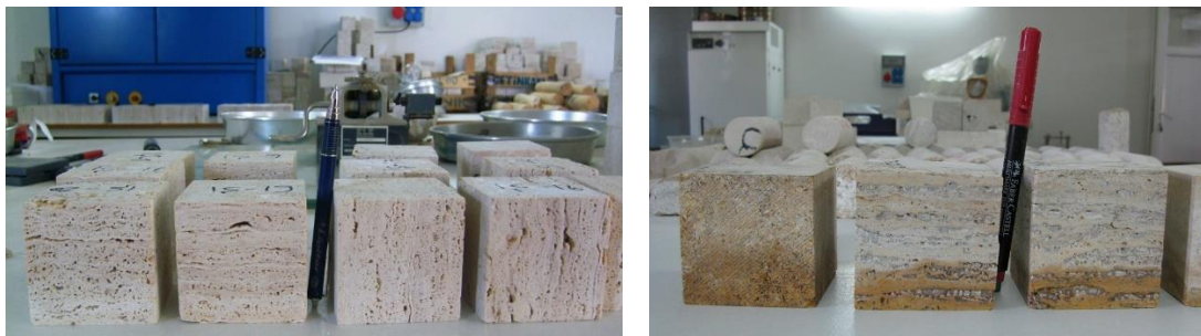
Şekil 3b. Traverten deney örneklerinde su yollu yapı ve kapiler su emme deneyi sonrası bir kısım örneklerin görünümü (sağda).
