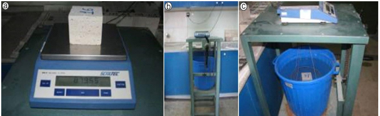
Şekil 3. Ulumuhsine kireçtaşı (Gödene taşı)'nın Arşimet terazisinde kuru ve doymuş ağırlık ölçümleri a) Arşimet terazisinde kuru tartım, b) Su içinde tartım genel görünüm, c) Arşimet terazisinde su içinde tartım
