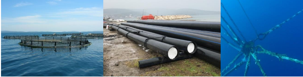
Şekil 2 a, b ve c. Yüzer ağ kafes üniteleri (a), kafes yapımında kullanılan polietilen borular (b) ve mooring sistemi (c).
