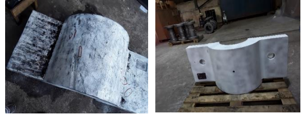
Şekil 7. a) Talaşlı imalat öncesi ve b) Talaşlı imalat sonrası dökümün kalite kontrol sonuçları
