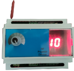
Şekil 10. Ana kontrol ünitesinin potansiyometre ile kontrol edilmesi
