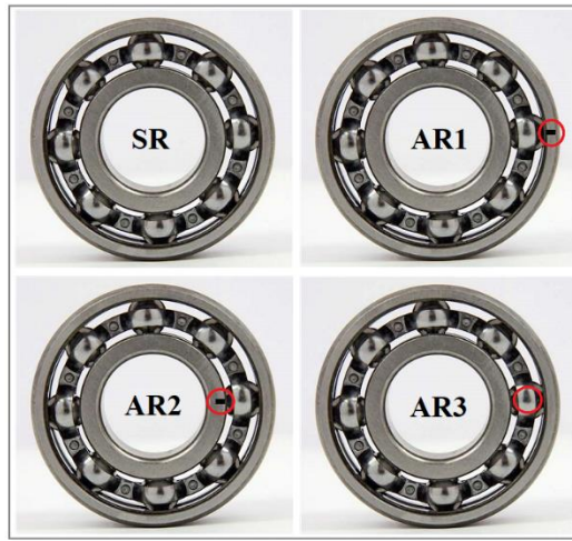
Şekil 3. Sağlıklı ve arızalı rulman gösterimleri (Skf Rulman Kataloğu) SR (sağlıklı rulman), AR1 (dış bilezik arızası), AR2 (iç bilezik arızası), AR3 (yuvarlanma elemanı arızası)
