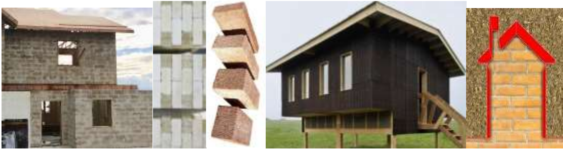
Şekil 5. Kenevirden elde edilen briket, yalıtım malzemesi ve inşaat sektöründe kullanımı
