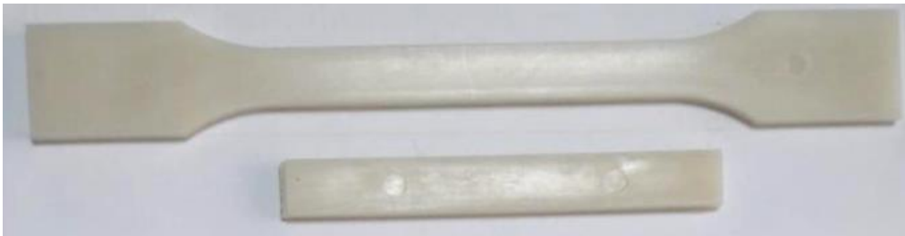
Şekil 1. Enjeksiyon kalıplama yöntemi ile üretilen çekme, darbe/eğme numuneleri
