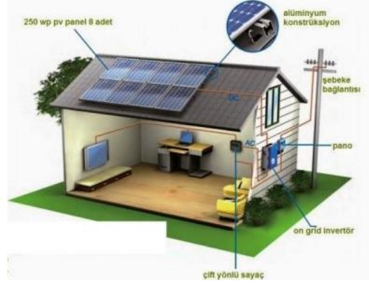
Görsel 19. Şebekeye Bağlı Fotovoltaik Sistem (Beykoz Belediyesi, 2016)
