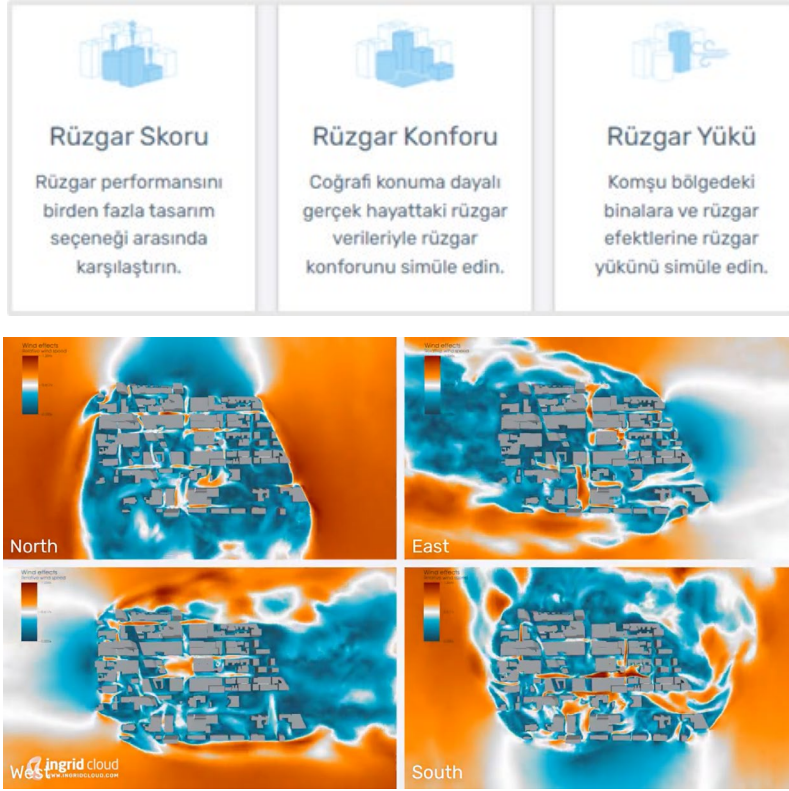
Şekil 17. Ingrid Cloud ile bina çevresinde yapılabilen rüzgâr simülasyonları (Ingrid Cloud, 2021)
