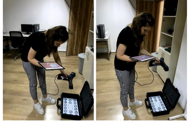
Şekil 2. FARO Freestyle 3D Tarayıcı kalibrasyon işlemi
