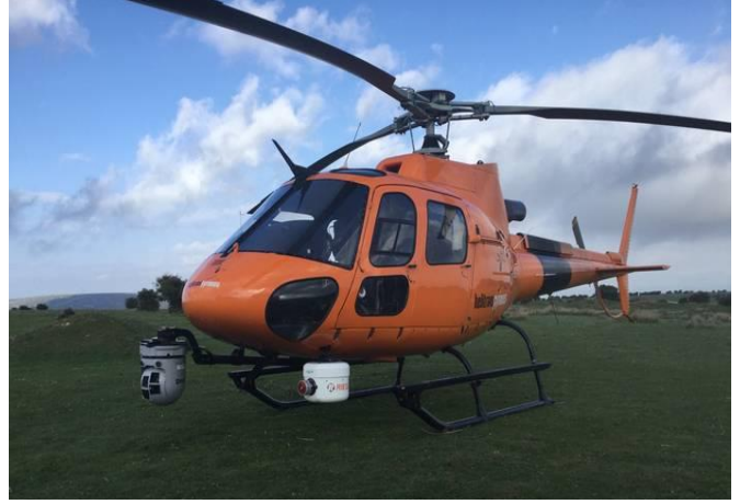
Şekil 5. Havasal lazer taramanın helikopter örneği (Emigrup, 2021).
