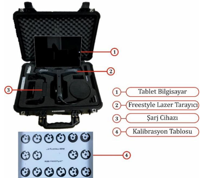
Şekil 1. FARO Freestyle3D elde taşınabilir lazer tarayıcı
