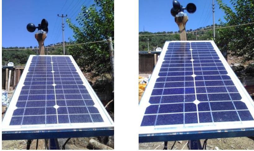
Şekil 5: Bölge 1 deki kurulu panellerin 30 gün sonundaki yüzey üzerindeki kirlenme ve çamurlaşmanın gösterimi
