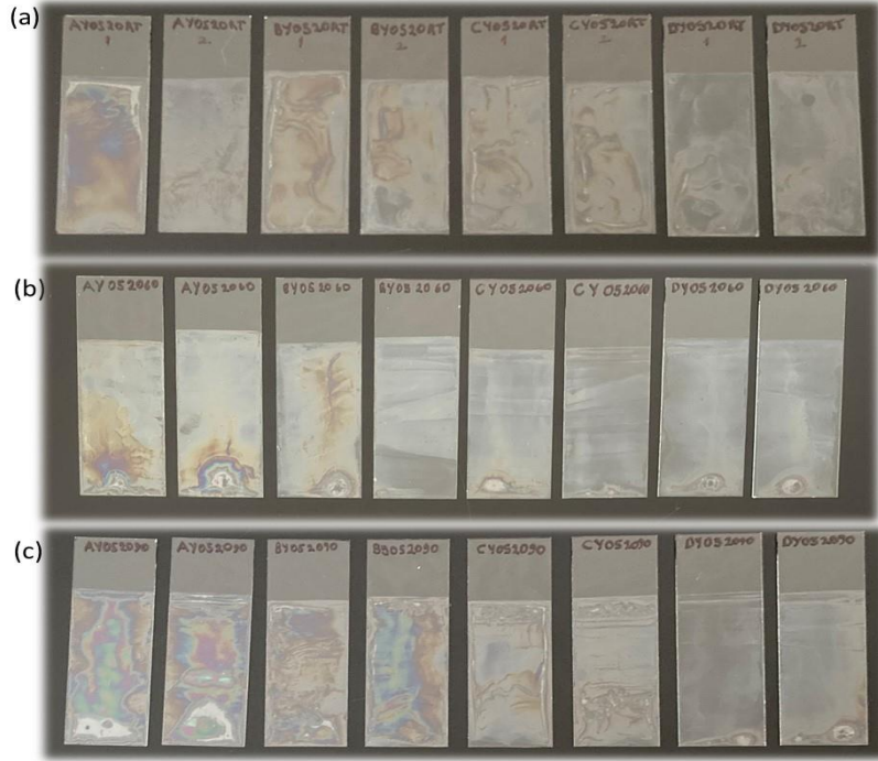
Şekil 2. Farklı konsantrasyon değerleri (soldan sağa azalan; A:1/2, B:1/4, C:1/6, D:1/8) için farklı tabla sıcaklıkları (yukarıdan aşağıya artan; (a) RT, (b) 60 °C, (c) 90 °C) kullanılarak üretilen cam/SnO 2 filmlere ait dijital görüntüler.
