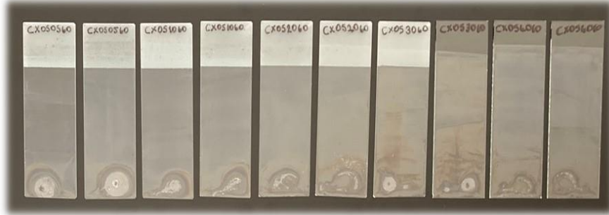
Şekil 8. Farklı büyütme hızlarında (solda sağa artan; 05, 10, 20, 30, 40 mm/sn) için üretilen cam/SnO 2 filmlere ait dijital görüntüler.
