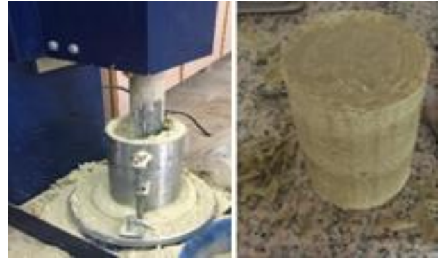
Şekil 6. Standard proktor deneyinin yapılışı ve sıkıştırılmış bir örnek
