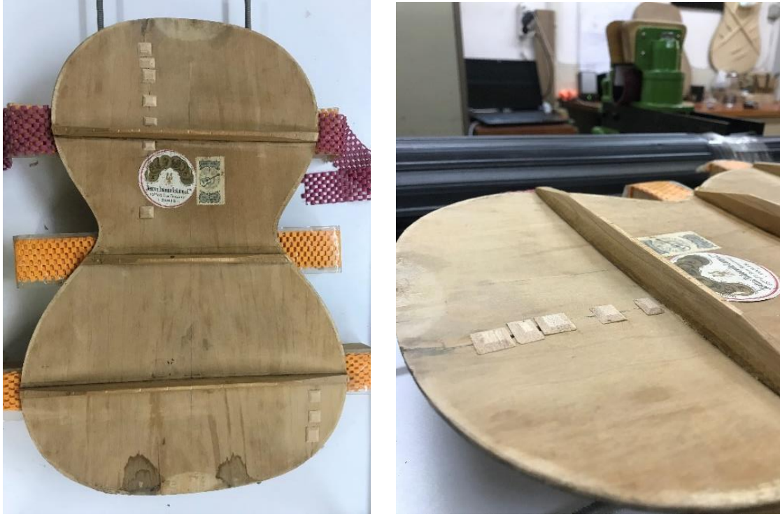
Fotoğraf 8. Romantik gitarın arka tahta çatlaklarına ağaç protezler yapıştırılması.
