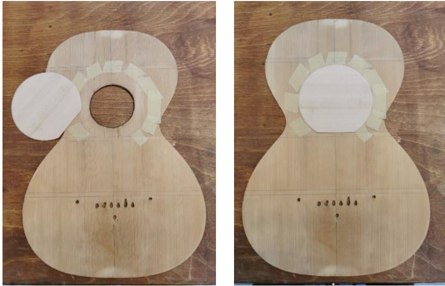
Fotoğraf 15. Ön tahtadaki ses deliği ve rozetin iç taraftan ladin ile desteklenmesi.
