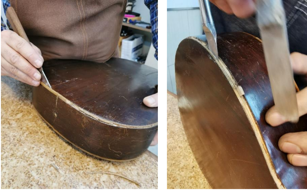
Fotoğraf 3. Romantik gitarın arka tahta kenar çitasının ve arka kapağının sökülmesi.
