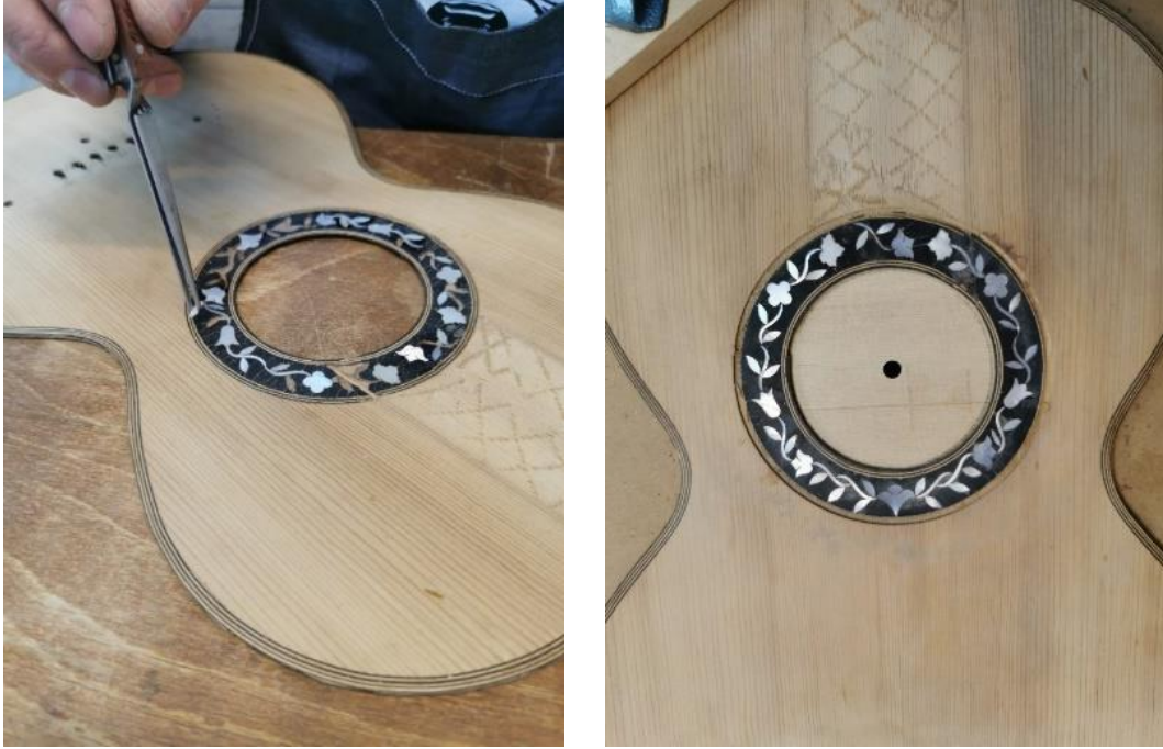
Fotoğraf 17. Ön tahtadaki rozet süslemelerinin onarımı.
