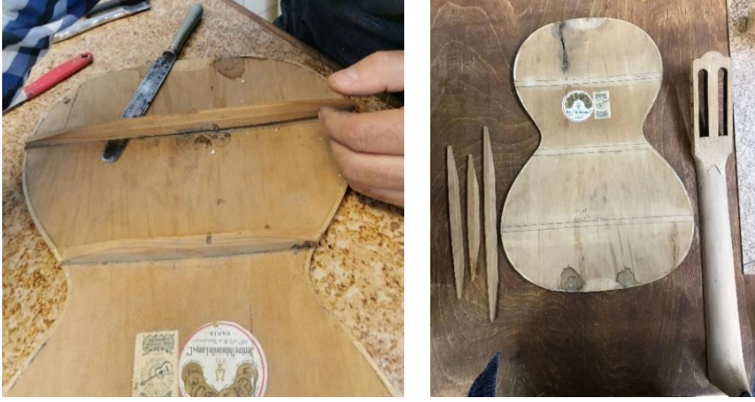
Fotoğraf 5. Romantik gitarın arka tahta kirişlerinin sökülmesi.
