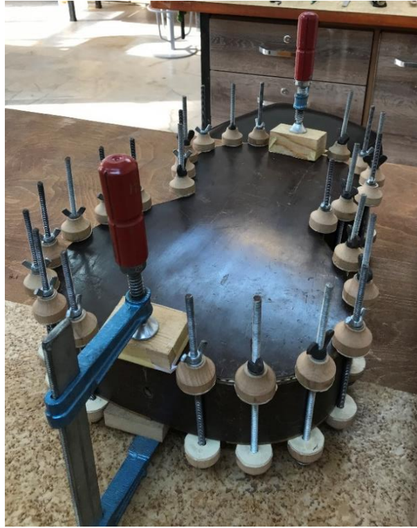
Fotoğraf 10. Romantik gitarın arka tahtasının yerine yapıştırılması.
