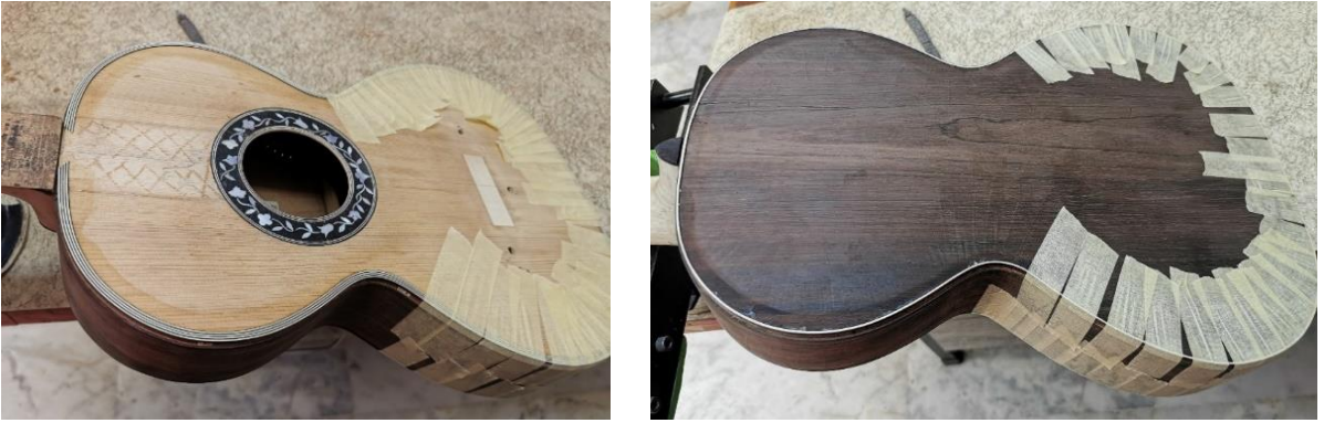
Fotoğraf 21. Romantik gitarın ön ve arka tahta kenarlarına filetolarının yapıştırılması.
