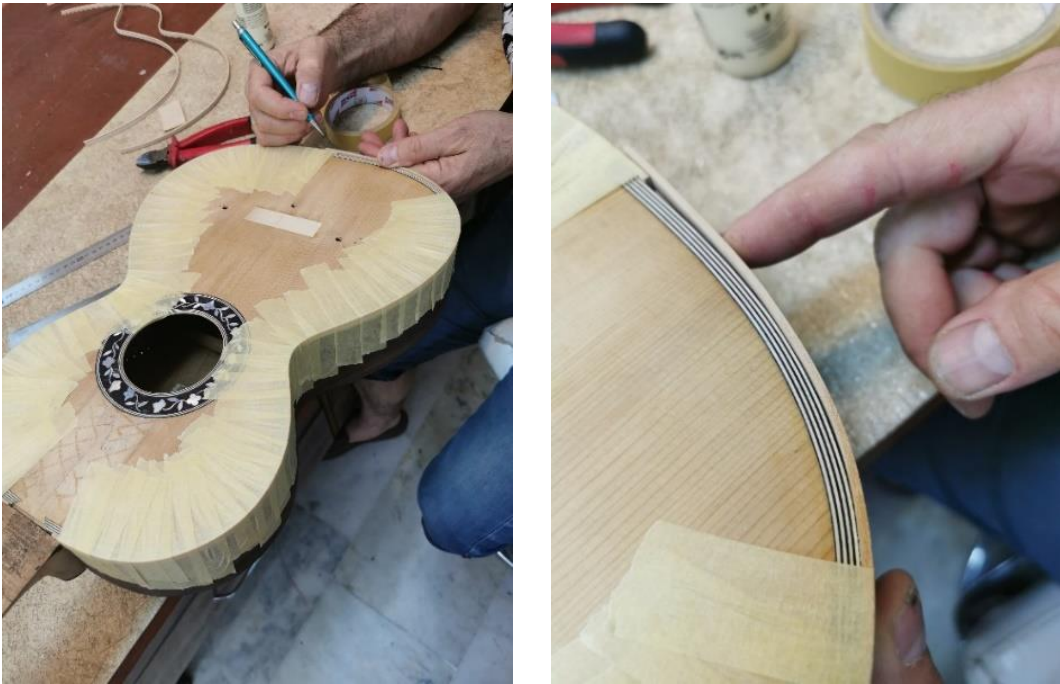
Fotoğraf 22. Romantik gitarın ön tahta kenarlarına akçaağaç kenar çıtası yapıştırılması.
