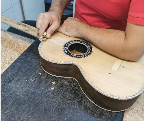
Fotoğraf 24. Romantik gitarın ön ve arka tahta kenar çitalarının temizliği.
