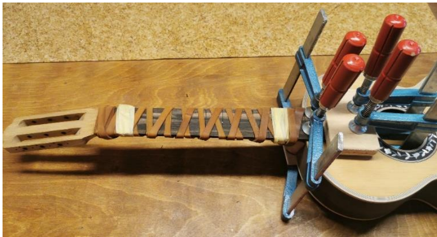
Fotoğraf 25. Romantik gitarın klavyesinin yapıştırılması.
