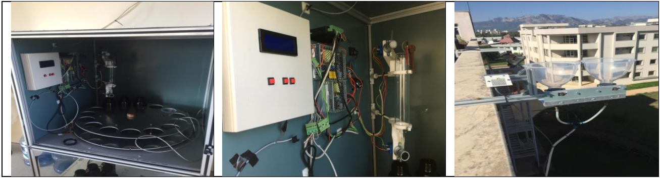
Şekil 1. Oto Örneklem Sistemi, Akış Kontrolü ve Sistemin Dış Ünitesi (Auto Sampling System, Flow Control and System Outdoor Unit)
