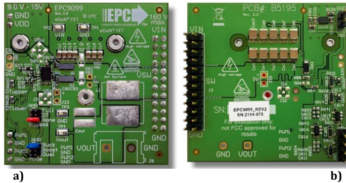
Şekil 7. EPC9099 Geliştirme kartı a) önden görünüş, b) Arkadan görünüş (EPC9099 Development board a) front view, b) rear view)
