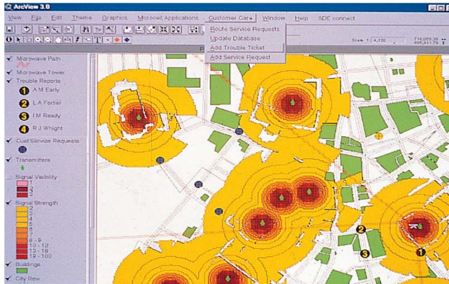
Şekil 4. Sinyal girişim temelli, baz istasyonlarının konumlanmasında CBS kullanımı (Use of GIS for positioning base stations based on signal interference) (C Fry, 1999)
