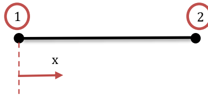
Şekil 2. Bir boyutlu doğrusal eleman (One dimensional linear element)
