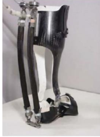
Şekil 11. Gordon ve arkadaşlarının tasarlamış olduğu aktif ortez [44].
