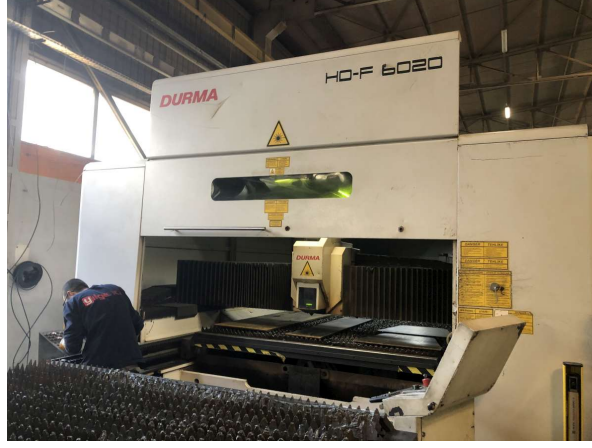
Şekil 2. Durma HD-F 6020 fiber lazer tezgâhı
