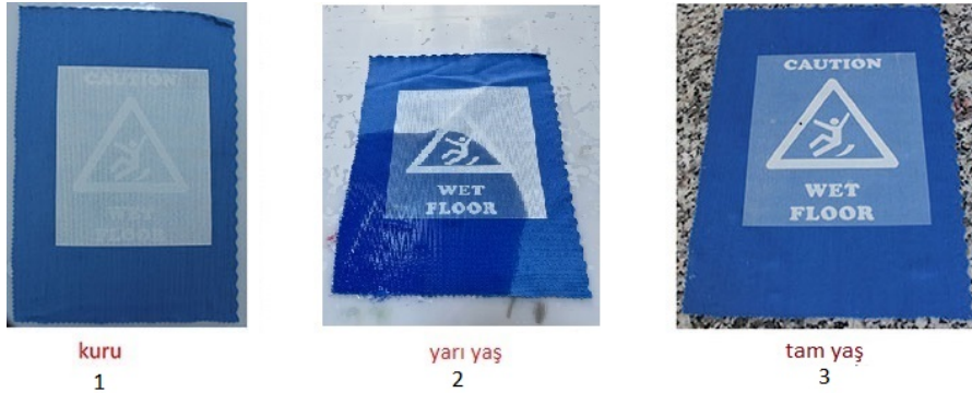
Görsel 8. 1: 4'lü hidrokromik baskı patı geçişli uygulama (kuru) 2: 4'lü hidrokromik baskı patı geçişli uygulama (yarı yağ) 3: 4'lü hidrokromik baskı patı geçişli uygulama (tam yağ)
