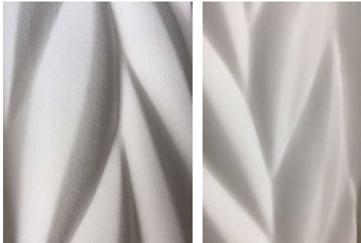
Görsel 6. Mum malzeme ile 3B yazma sonrası yüzeyin iyileştirilmesi (3PTek/Hao Zhao/Pekin)
