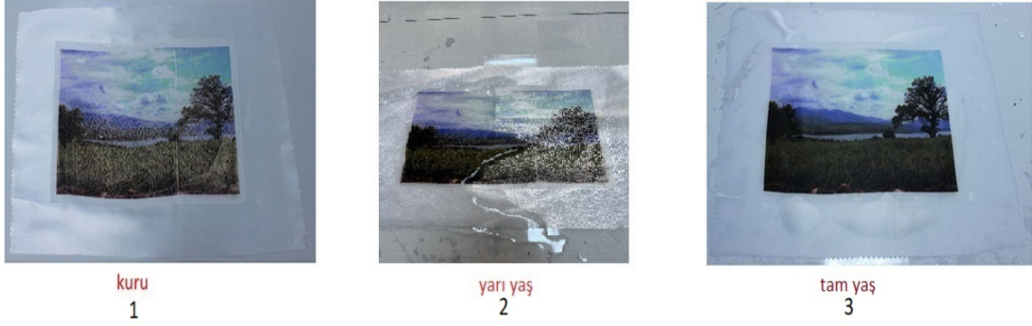
Görsel 11. 1: Dokuma saten yüzeye hidrokromik baskı patı uygulaması (kuru) 2: Dokuma saten yüzeye hidrokromik baskı patı uygulaması (yarı yaş) 3: Dokuma saten yüzeye hidrokromik baskı patı uygulaması (tam yaş)
