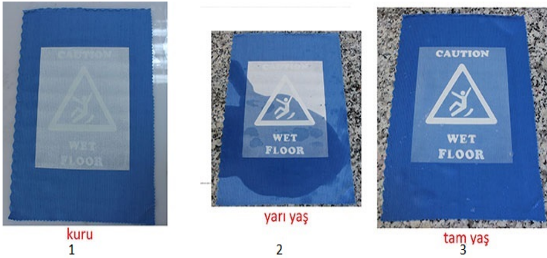
Görsel 7. 1: 2'li hidrokromik baskı patı geçişli uygulama (kuru) 2: 2'li hidrokromik baskı patı geçişli uygulama (yarı yaş) 3: 2'li hidrokromik baskı patı geçişli uygulama (tam yaş)
