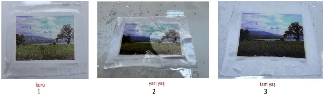
Görsel 12. 1: Triko kadife yüzeye hidrokromik baskı patı uygulaması (kuru) 2: Triko kadife yüzeye hidrokromik baskı patı uygulaması (yarı yaş) 3: Triko kadife yüzeye hidrokromik baskı patı uygulaması (tam yaş)
