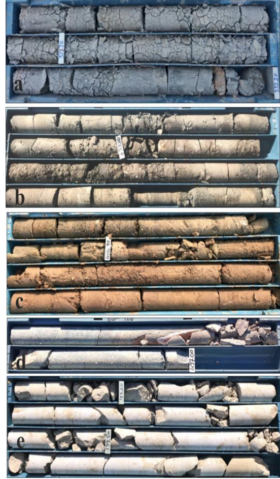
Şekil 2. Karot fotoğrafları a) TS1 sondajına ait grimsi yeşil renkli kuruma çatlaklı kilaşı seviyeleri, b) TS1 sondajına ait yer yer koyu grimsi-koyu kahverengi arasında değişen organik maddece zengin kilaşı ve çamurtaşları, c) TS2 sondajına ait sarımsı kahve renkli karbonatlı çamurtaşı, kumtaşı seviyeleri, d) TS2 sondajına ait andezit ve dasit bileşimli, porfirik dokulu ayrılmış Kretase yaşlı volkanitler, e) TS3 sondajına ait kristalize kireçtaşı.
