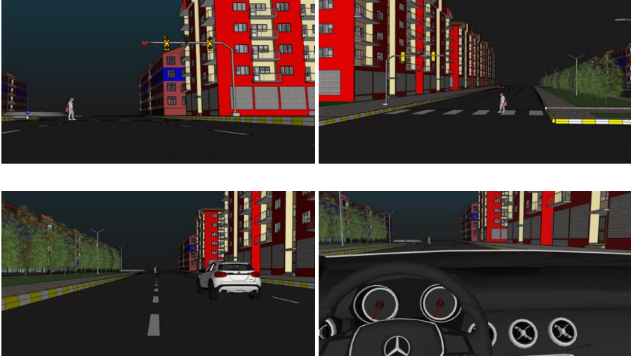
Şekil 9. Gece karanlık saatlerde algılayıcı sistem tarafından yolda yaya ve aracın aynı anda algılandığı duruma ait simülasyon görselleri (Yazar, 2022).
