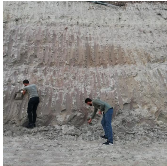
Şekil 2. Adıyaman üniversitesi girişinde yüksek sıkılıktaki siltli zemin katmanı
