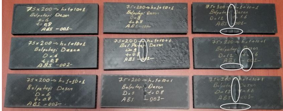
Şekil 11. ABS numunelerin eğme testi sonrası üst görüşleri
