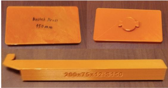
Şekil 6. Eğme testleri için üretilen özel aparat
