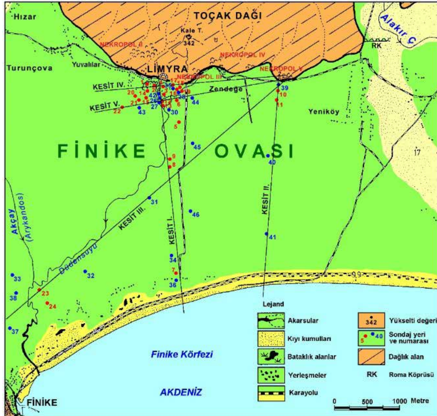
Şekil 3: Antik Limyra kenti ve Finike ovasında yapılan alüvyon delgi sondaj noktaları ve sondaj verilerine göre hazırlanan kesit doğrultuları (Öner 2013). Figure 3: Vibracoring sites and the location of sedimentological cross-sections in the ancient city of Limyra and Finike plain (Öner, 2013).
